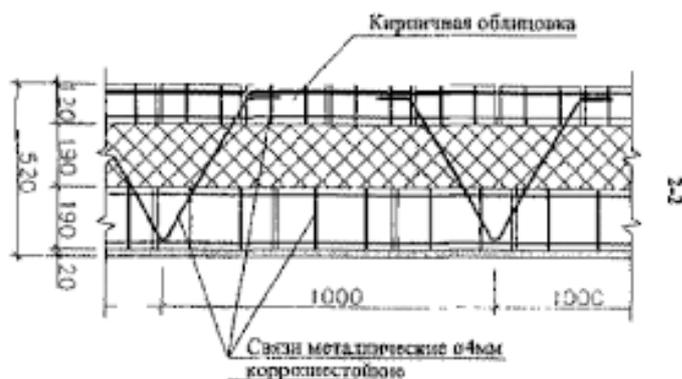
Рисунок 22. Схема стяжки.
