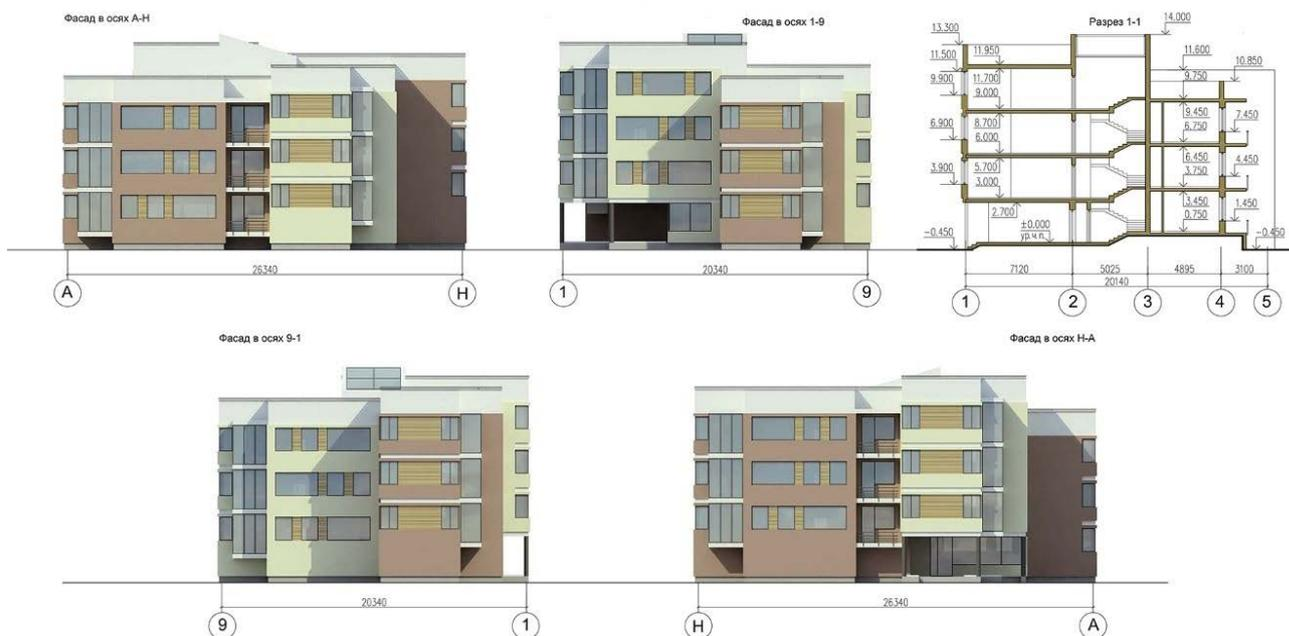
Рисунок 2. Фасады в осях и в разрезе.
